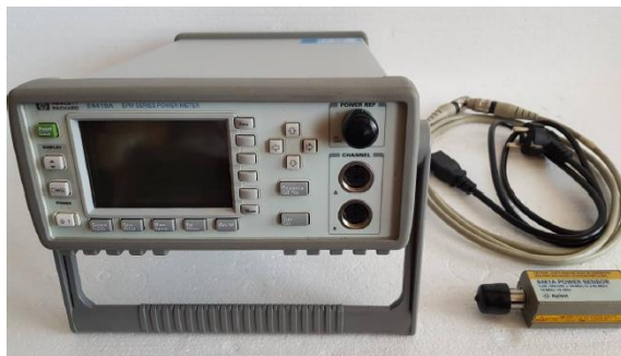
Slika 3. Predmet etaloniranja: vatmetar HP / Agilent E4419A sa senzorom 8481A
